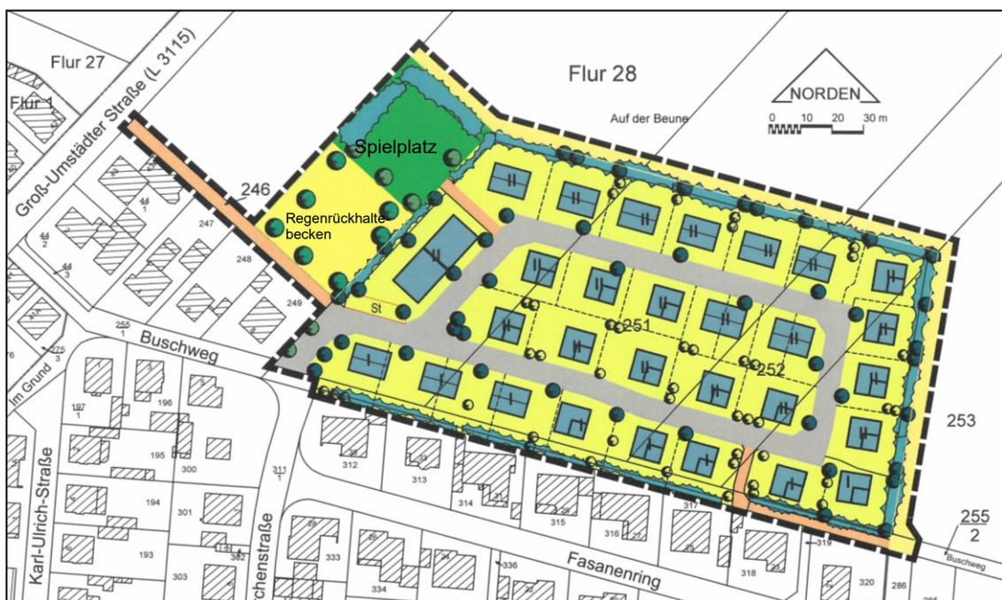
Abb. 18: Städtebauliches Konzept Jan. 2020 mit aktuell geplantem Standort eines Regenrückhaltebeckens
