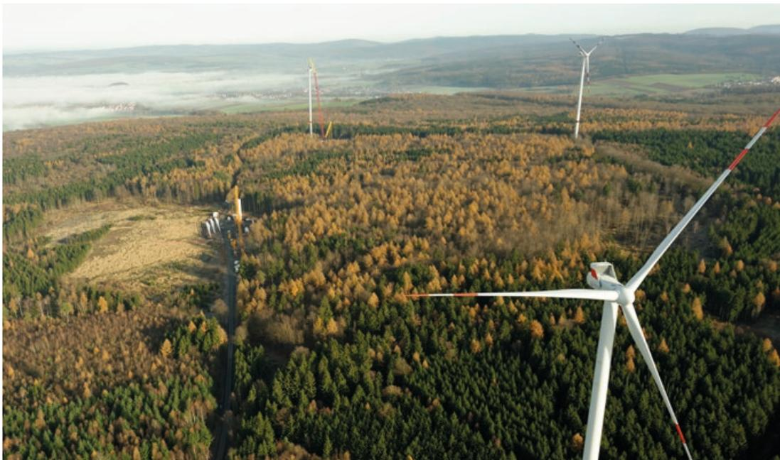
Abbildung 9: Optimierung der Standortplanung mit einer bestehenden Windwurffläche und bestehenden Wegenetzen (Quelle: Aibotix GmbH, Kassel)
